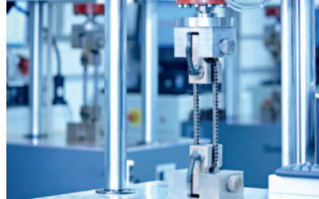
Dauerfestigkeits- und Zeitfestigkeitsüberprüfungen durch mehr als 15 Pulsatoren nach unterschiedlichen Prüfungsverfahren
